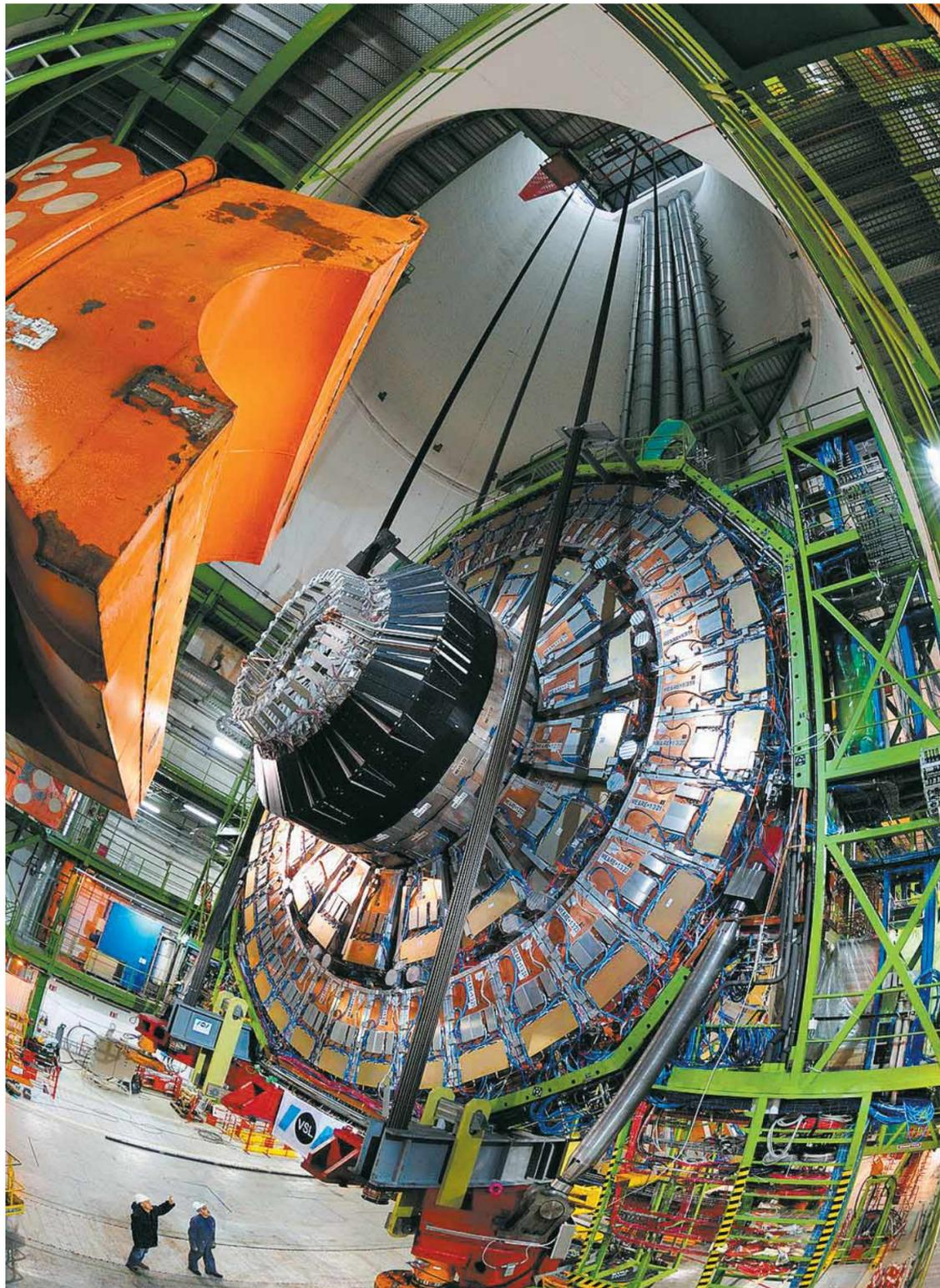
Techniker montieren den CMS-Detektor, eine der vier Kameras, durch die der Beschleunigerring läuft. Sie sollen jede Teilchenkollision registrieren
